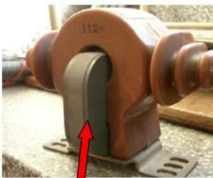
電磁材料(コイルの鉄心)
